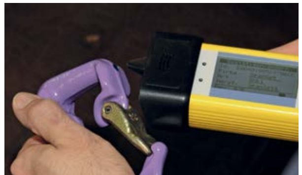
IDXchanger MDE 2 IDXpin'den metalik ortamda veri okuyor.
